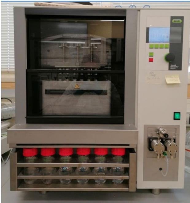
**Figura 4.** Sistema di estrazione PLE (Speed Extractor E-916 system, Buchi, Italia)
